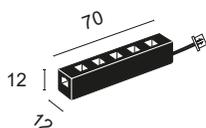
Box obbligatorio per la connessione in SERIE-PARALLELO dei Microspot DUST e SKY. Al box si possono connettere esclusivamente tre o sei Microspot. Il box è dotato di connettore per moltiplicatore.
